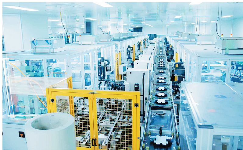
河南克能新能源科技有限公司电芯智能化装配生产线(资料图)
