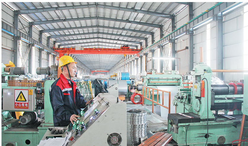
工人在纵剪设备前精准操作
