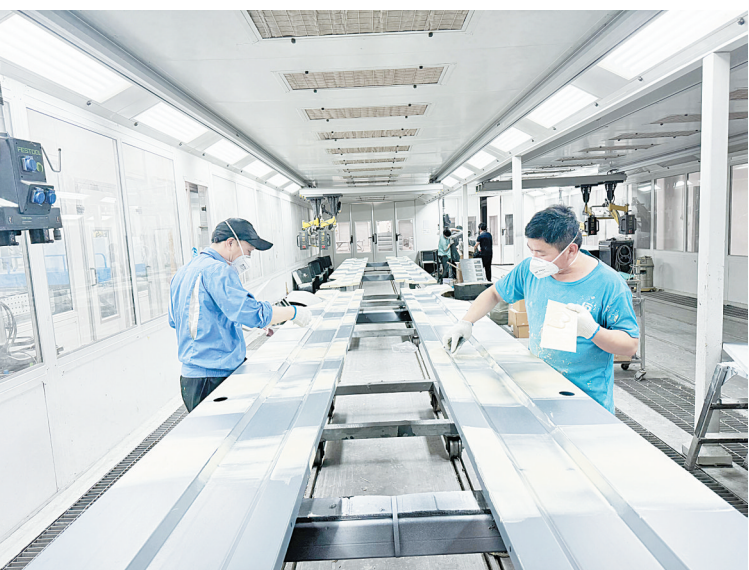
在河南犀重涂装车间底处理室,工人正在刮灰作业
