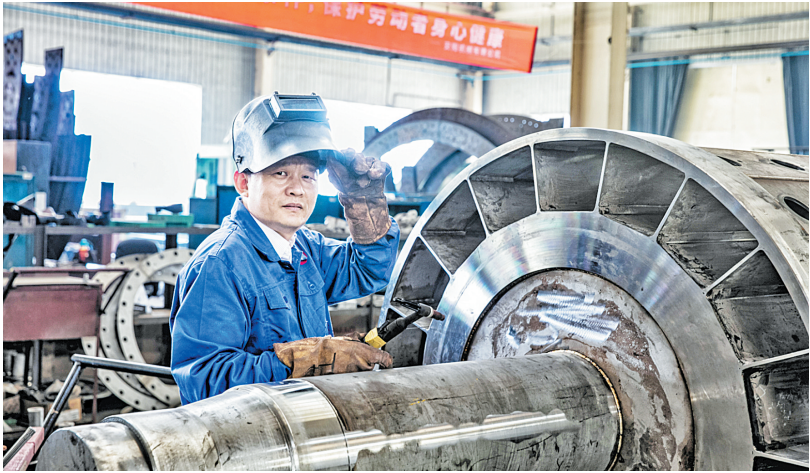
张政伟在进行多盘式真空过滤机端面密封焊接(资料图)
