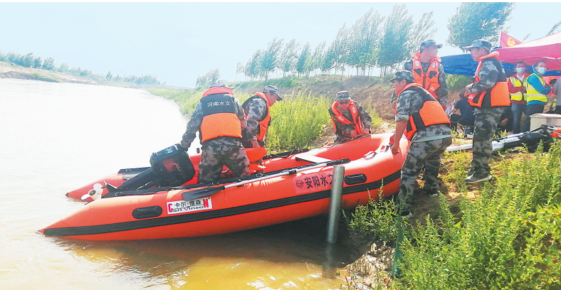
突击队员使用橡皮艇搭载ADCP测流
