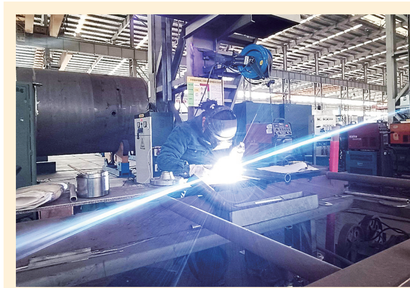
春节期间,为保证项目顺利推进,安阳方快锅炉有限公司员工坚守生产现场,奋力实现首季开门红,为推动企业高质量发展贡献力量。图为工人正在焊接锅炉冷凝器集箱部件。(本报记者 姚芳 摄)
