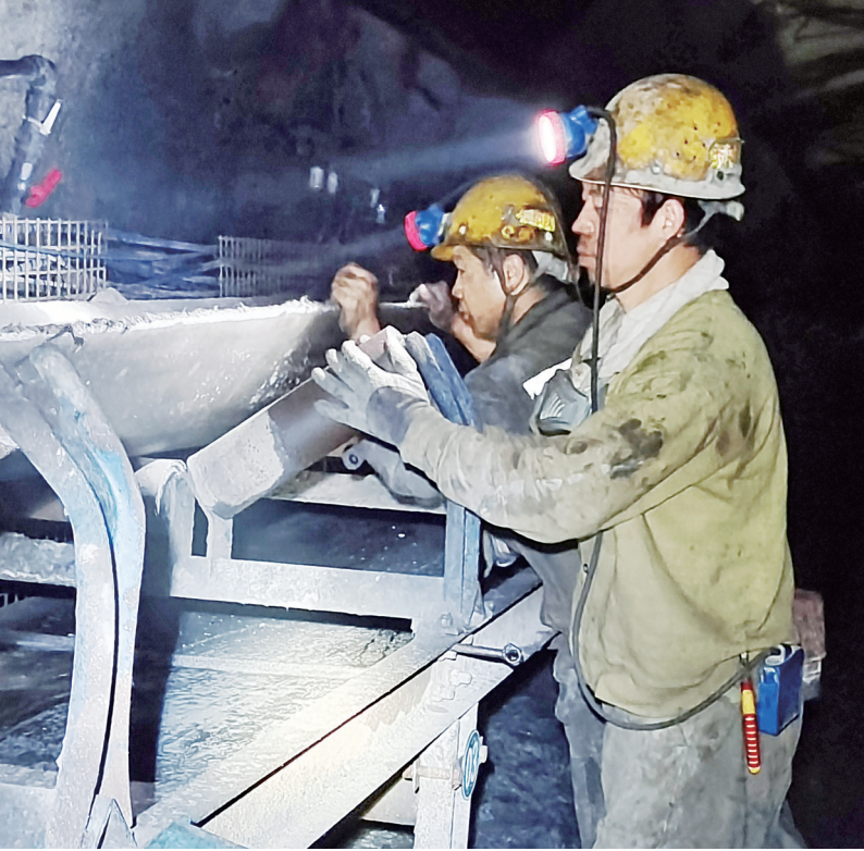
该矿开拓队机电工正在调整新延伸的皮带设备(任毅俊 摄)
