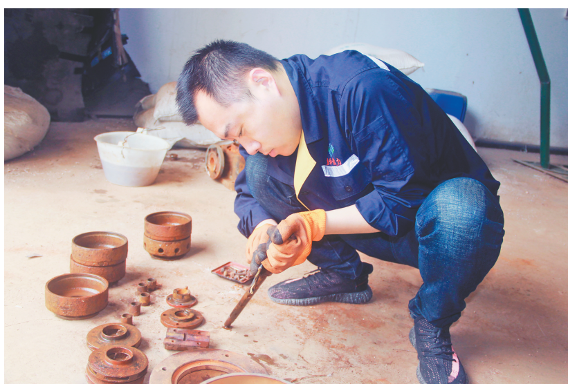
工作人员正在拆卸循环泵(张承 摄)
