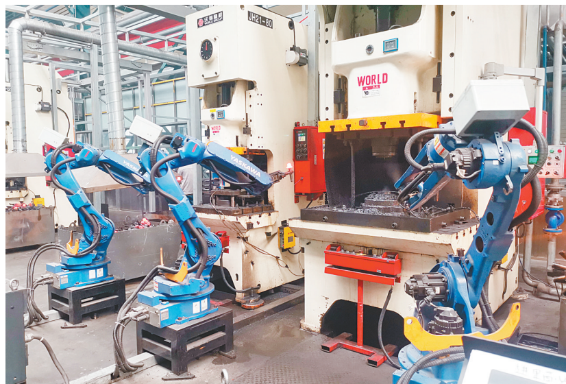
福斯罗(安阳)轨道装备有限责任公司螺旋道钉生产区内,3个工业机器人正在作业
