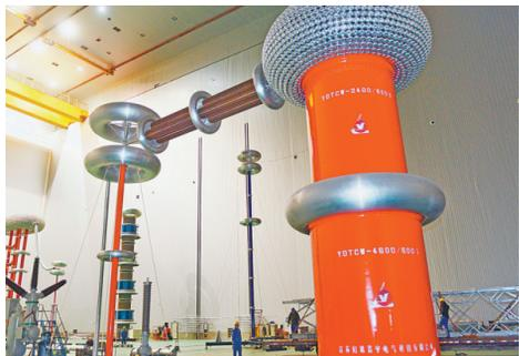
技术人员在河南省高压电器研究所有限公司特高压绝缘试验大厅内安装测试设备
