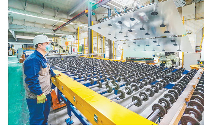
安彩光伏玻璃生产线
