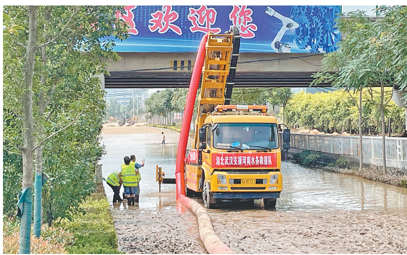
“龙吸水”泵车在辛瓦路涵洞下穿通道抽水(本报记者 魏兰 摄)
