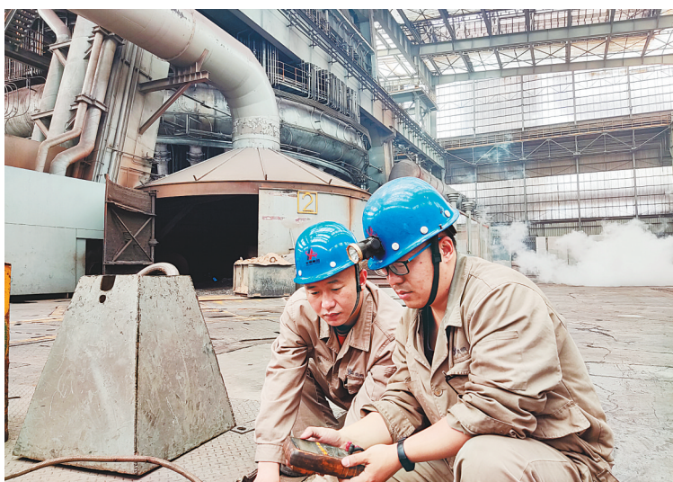
一线工人在安钢3号高炉现场点检铁水液面计(李栓柱 摄)
