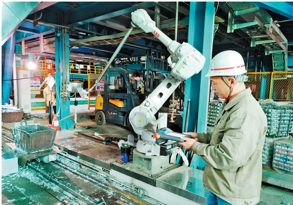
邓保峰在安钢冷轧公司测试铸钢渣机器人
