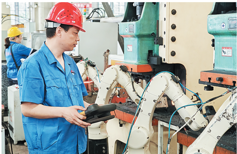
王运平对机器人运行轨迹进行检测和调试(资料图)
