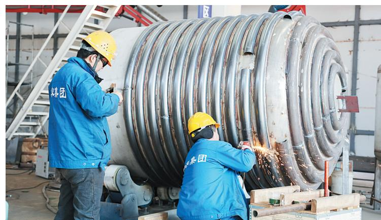
华泰机械员工正在制作印度日处理15吨米糠项目配套设备恒温罐
